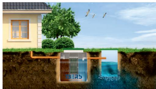
Отвод при низком уровне грунтовых вод – в дренажный колодец
