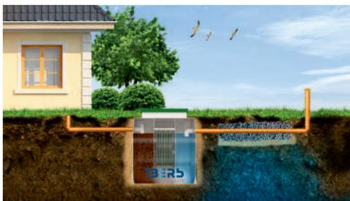
Отвод при низком уровне грунтовых вод – в дренажную трубу
