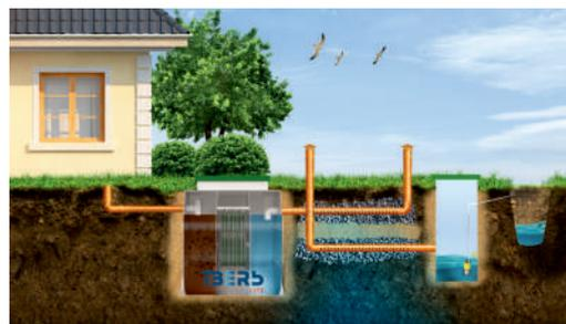
Отвод при низкой пропускной способности грунта и высоком уровне грунтовых вод – в приемный колодец
